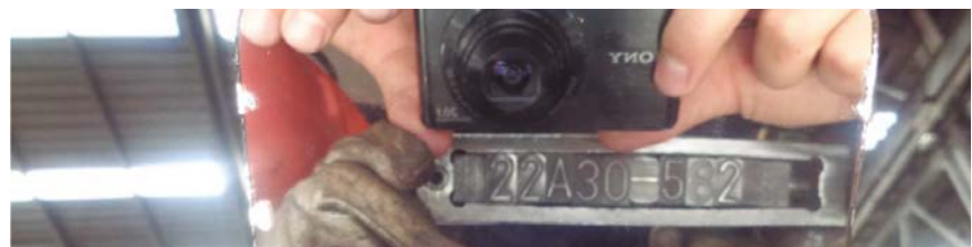
DESPUÉS KAIZEN :: Se instaló espejo que permite revisar la marca en el sentido correcto.
