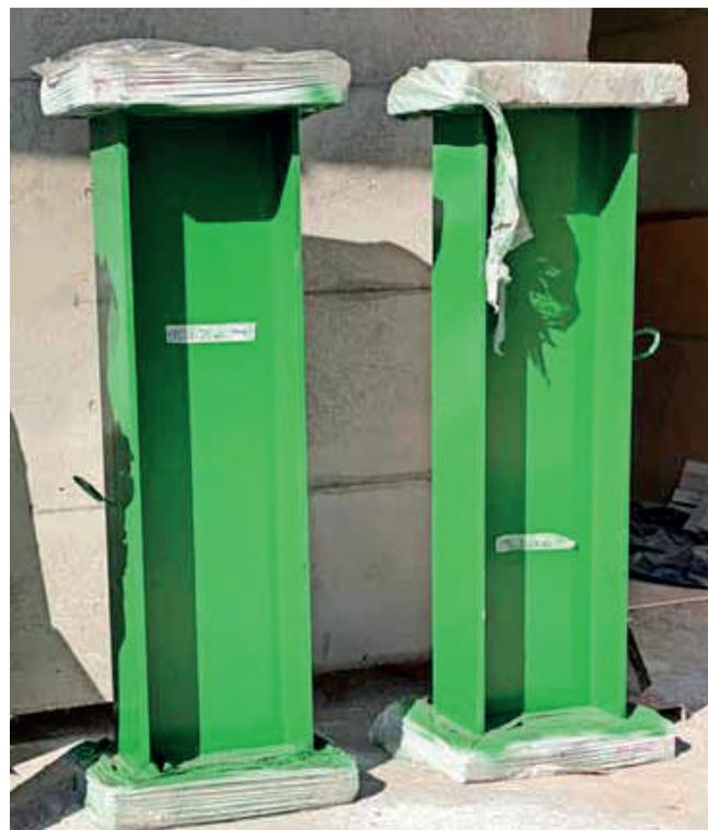
año, se realizaron ensayos en los laboratorios de Idiem, entidad que cuenta con el único horno certificado en Chile. El factor de retardo definido para la prueba fue F-30 para una masividad de la pieza de 125 m<sup>3</sup>, en donde fueron aplicados 450 micrones de pintura intumescente (según determinación de esquema que permita el factor de retardo
